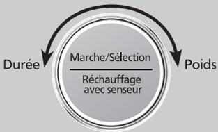
Régler la durée différée désirée en tournant le sélecteur (jusqu'à 1 heure et 30 minutes).
